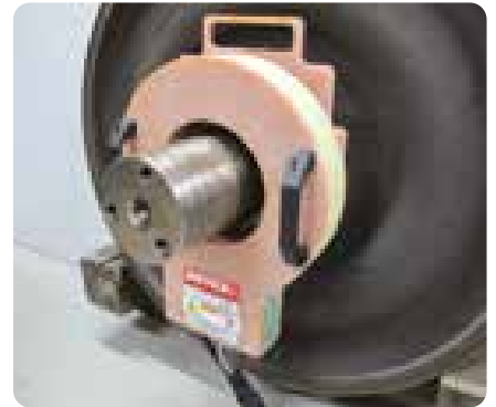
Chauffe d'un joint labyrinthe pour démontage
