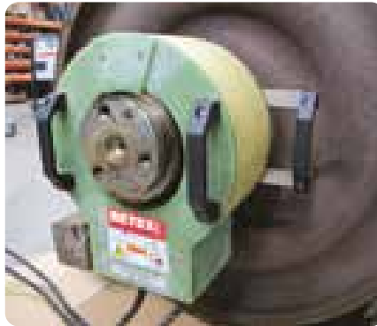
Chauffe d'une bague de roulement pour démontage
